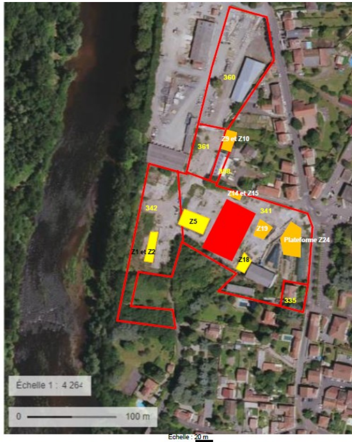
contamination résiduelle (1 mg/kg<PCB<2 mg/kg et 500mg/kg<HCT<1500 mg/kg) contamination résiduelle (PCB<2 mg/kg et HCT<2500 mg/kg) contamination résiduelle HCT > 2500 mg/kg (Confinement) FIGURE 9 : PLAN DES CONTAMINATIONS RESIDUELLES
