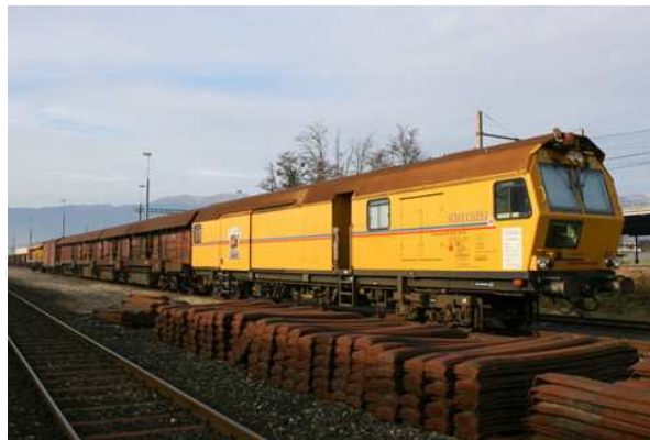
Train meuleur de rails (Scheuchzer S.A.)
