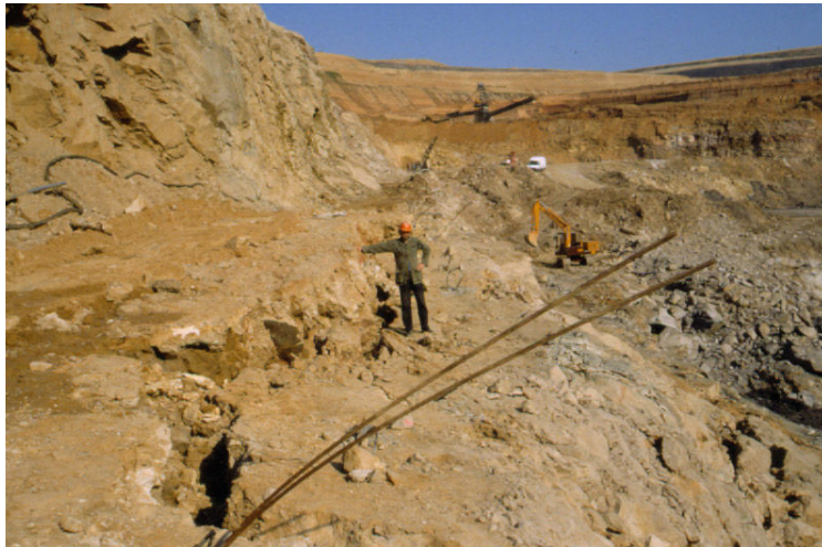
Photo 10 : Glissement d'un compartiment rocheux découpé par deux failles majeures et sous-miné par d'anciens travaux miniers souterrains. Grande découverte de charbon de Carmaux.
