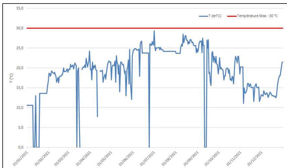
Figure 36 : Suivi de la température des lixiviats traités et rejetés en 2021
