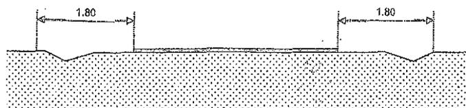
Schéma n° 2 : avec obstacles physiques (mur, parapet, falaise...) – entre pied de falaise ou mur de soutènement, et parapet
